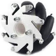
메카넘 휠의 롤러는 휠의 힘 벡터의 방향을 45도 만큼 바꿔 준다. 이 원리를 통해 휠의 회전 방향을 조절하여 기기의 방향전환 없이 전방향 이동이 가능한 휠이다.
